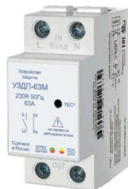
Устройство защиты от дугового пробоя УЗДП (далее Устройство) предназначено для отключения оборудования при обнаружении дугового пробоя в контролируемой цепи или опасного искрения в электропроводке, а так же, при опасном повышении сетевого напряжения в однофазных сетях. Устройство разработано в соответствии с требованиями стандарта ГОСТ IEC 62606-2016 "Устройства защиты бытового и аналогичного назначения при дуговом пробое. Общие требования".
