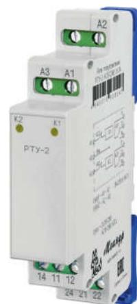
Реле телеуправления РТУ-2 (далее - реле) предназначено для применения в схемах телемеханики для управления двухпозиционным объектом. Реле имеет электрическую блокировку при управлении двумя взаимоисключающими потребителями. Возможно применение в схемах управления задвижками и др. двухпозиционными объектами. Находит широкое применение в схемах телемеханики метрополитена. Технические характеристики приведены в таблице.
