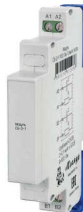
Модуль СБ-2-1 (далее модуль) предназначен для защиты коммутирующих контактов от разрушительного действия выбросов напряжения возникающих при коммутации обмоток электромагнитных устройств, таких как: реле, контакторы, электромагнитные пускатели и пр. Также модуль может применяться для уменьшения скорости нарастания напряжения  $dU/dt$  различных силовых полупроводниковых приборов (мощные транзисторы, тиристоры, симисторы и пр.). Технические характеристики приведены в таблице.
