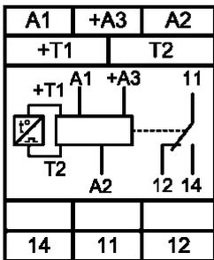
В изделиях с исполнением AC230В напряжение питания ACDC24В подаётся на клеммы «+А3», «А2». При питании реле постоянным напряжением «+Упит» подключать на клемму «+А3». Напряжение питания AC230В подаётся на клеммы «А1», «А2». На А1 подается L - фаза, на А2 подается N - нейтраль.
