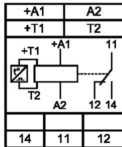
В изделиях с исполнением ACDC10-30В напряжение питания подаётся на клеммы «+А1», «А2». При питании реле постоянным напряжением «+Упит» подключать на клемму «+А1».
