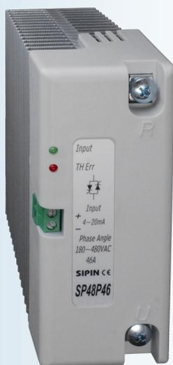
Данные тиристорные регуляторы мощности используются во всех отраслях промышленности, где необходимо управлять активными нагрузками, например, в промышленных печах, при переработке пластмасс, на транспорте. Тиристорный регулятор мощности состоит из двух встречно параллельно-включённых силовых тиристоров. Изолированного радиатора и схемы управления.
