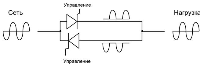
В режиме 50% мощности (тиристоры открыты на середине полупериода) работа тиристорного блока выглядит так (режим Phase Angle):
