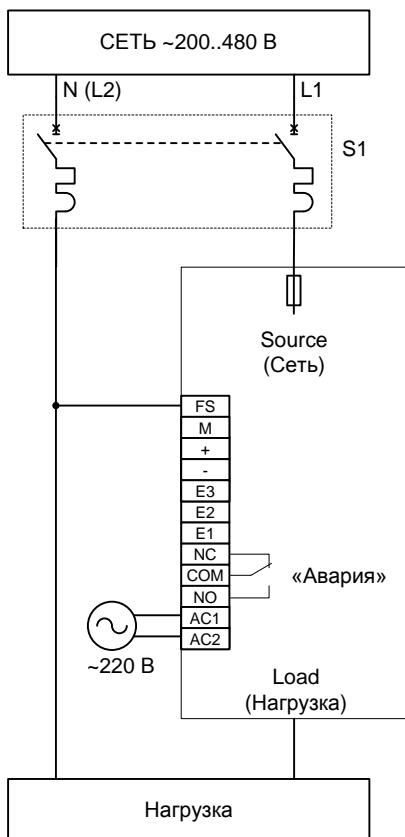
С использованием аварийного отключения и сигнализации:
