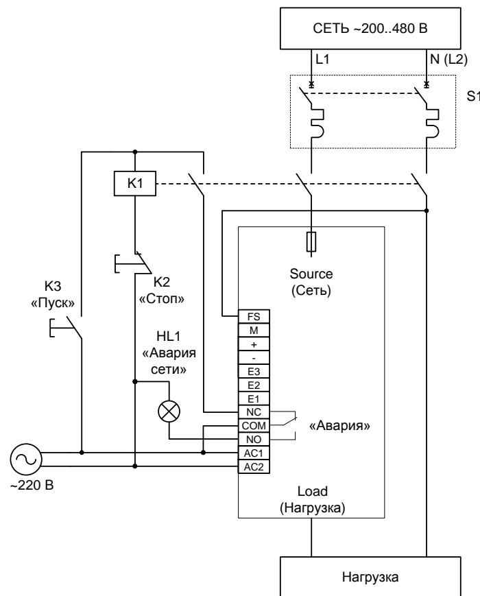
Контакт **FS** предназначен для контроля наличия сети на входе (Source) и подключается в соответствии с общей схемой включения питания и нагрузки тиристорного регулятора. Без подключения этого контакта регулятор работать не будет.
