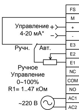
В этом режиме в «Авт.» положении переключателя или реле регулировка мощности осуществляется управляющим сигналом **4-20 mA\*** до **максимального значения, заданного внешним потенциометром**, а в положении «Ручн.» - **полностью внешним потенциометром**, переключение между режимами управления осуществляется переключателем или контактами реле.
