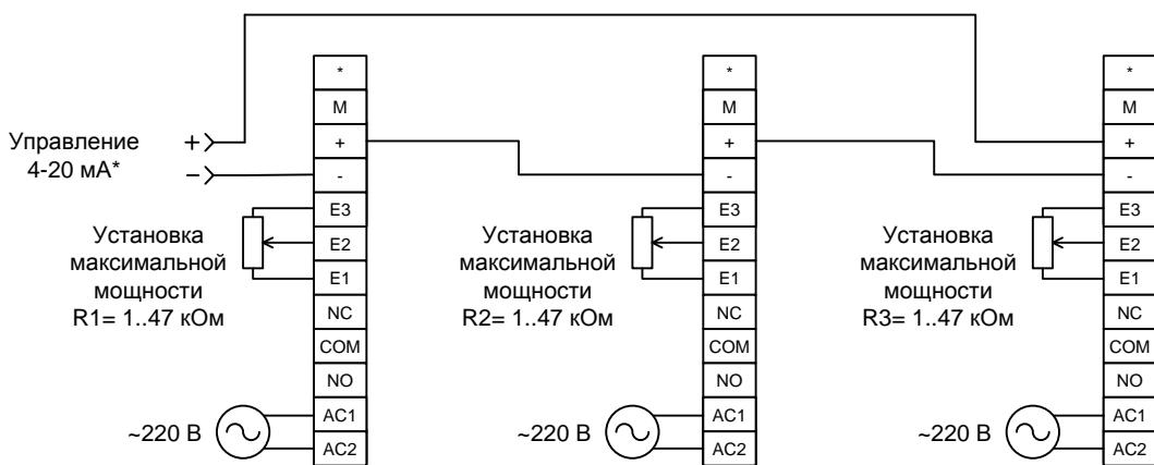
В этом режиме регулировка мощности осуществляется управляющим сигналом **4-20 мА\***, а **верхний предел регулировки мощности задается внешними потенциометрами для каждого регулятора отдельно**.
