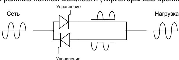
А так работа тиристорного блока выглядит при работе в режиме Phase Angle при мощности 50% (тиристоры открываются на середине полупериода):
