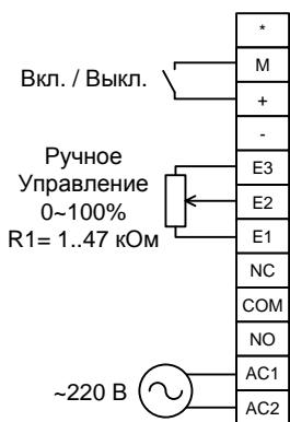
В этом режиме регулировка мощности осуществляется **внешним потенциометром**, а включение и выключение нагрузки – **внешним контактом** (выключатель, реле и т.п.)
