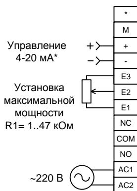
В этом режиме регулировка мощности осуществляется **управляющим сигналом 4-20 mA\***, а **верхний предел регулировки мощности задается внешним потенциометром**. Входной сигнал **4-20 mA\*** подается с соблюдением полярности на контакты «+» и «-», его значение не должно превышать значений, заданных установками типа и диапазона входного сигнала
