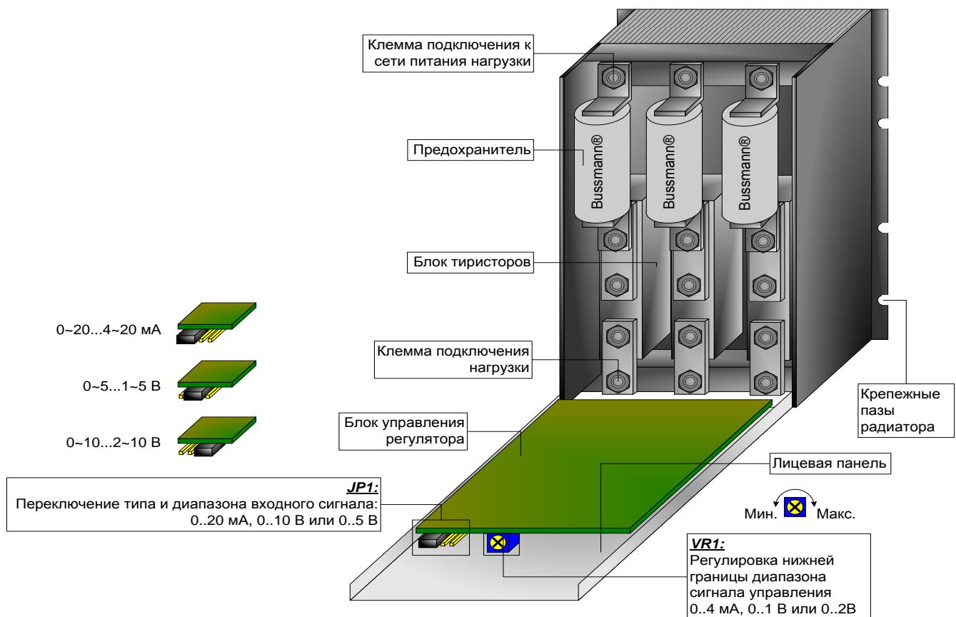
Крепление тиристорного регулятора осуществляется с помощью крепежных пазов радиатора.
