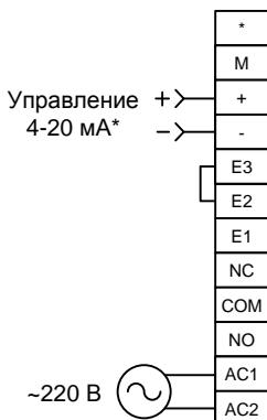
Входной сигнал **4-20 мА\*** подается с соблюдением полярности на контакты «+» и «-», его значение не должно превышать значений, заданных установками типа и диапазона входного сигнала. Контакты **E2** и **E3** должны быть замкнуты перемычкой, при разомкнутых контактах управление невозможno.
