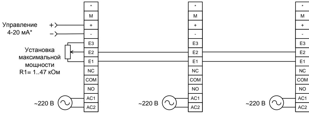
В этом режиме регулировка мощности осуществляется управляющим сигналом **4-20 мА\***, а **верхний предел регулировки мощности задается внешним потенциометром одновременно для всех регуляторов**.
